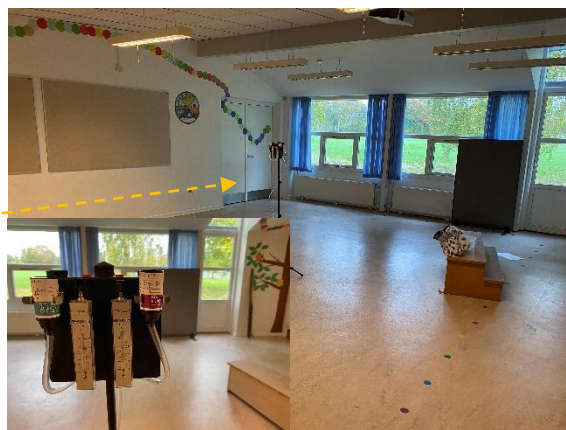
#94 Støvprøve P60-P61 og luftprøve MFAI27 er udtaget fra indeklimaet.
