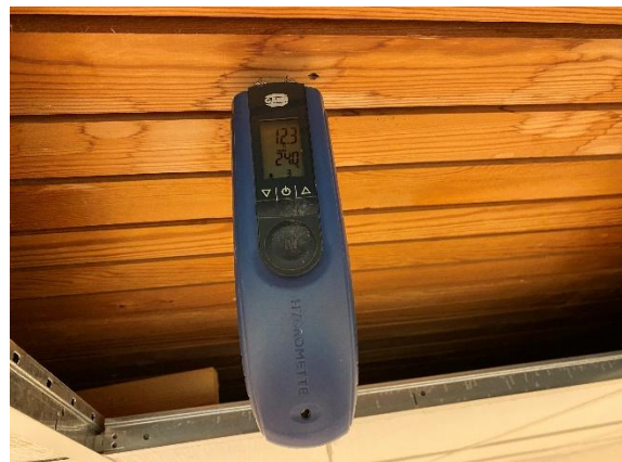
#36 Loftlister måles tørre. Prøve P/T24 er udtaget fra misfarvning på loftliste.
