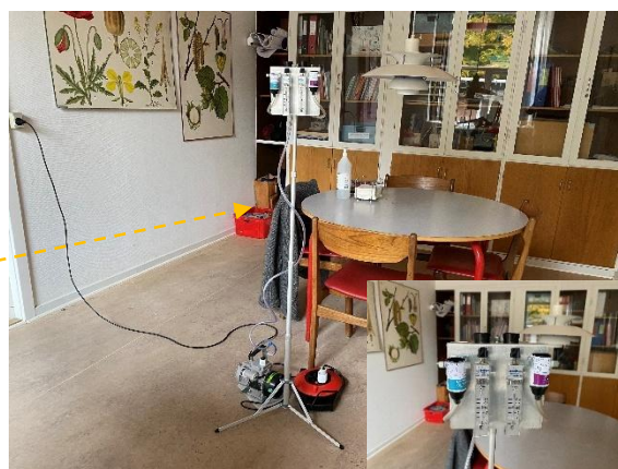
#88 Støvprøve P54-P55 og luftprøve MFAI24 er udtaget fra indeklimaet.
