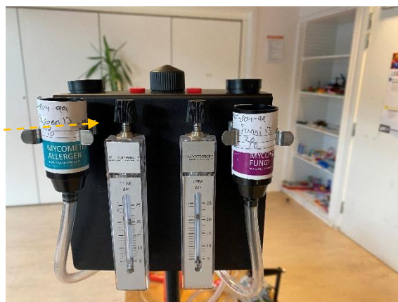
#66 Støvprøve P36-P37 og luftprøve MFAI13 er udtaget fra indeklimaet.
