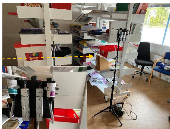
#82 Støvprøve P48-P49 og luftprøve MFAI21 er udtaget fra indeklimaet.
