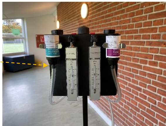
#60 Støvprøve P32-P33 og luftprøve MFAI10-MFAI11 er udtaget fra indeklimaet.
