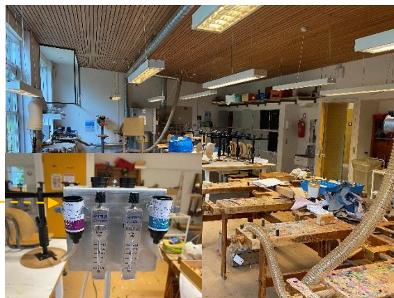
#98 Støvprøve P64-P65 og luftprøve MFAI29 er udtaget fra indeklimaet.
