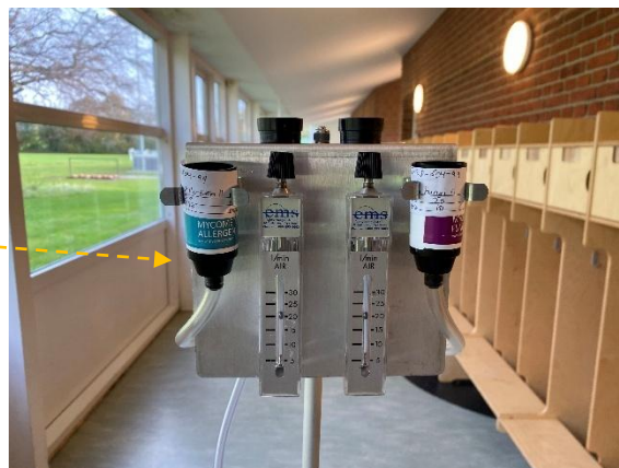
#62 Støvprøve P32-P33 og luftprøve MFAI10-MFAI11 er udtaget fra indeklimaet.
