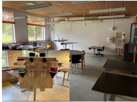
#110 Støvprøve P76-P77 og luftprøve MFAI35 er udtaget fra indeklimaet.
