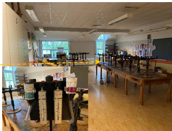
#96 Støvprøve P62-P63 og luftprøve MFAI28 er udtaget fra indeklimaet.
