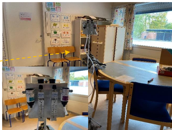
#80 Støvprøve P46-P47 og luftprøve MFAI20 er udtaget fra indeklimaet.
