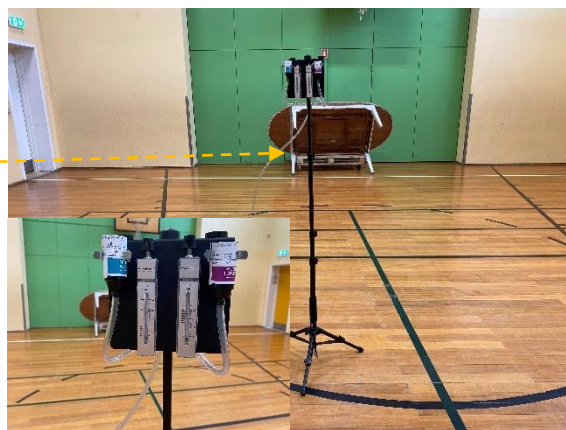
#76 Støvprøve P44-P45 og luftprøve MFAI18-MFAI19 er udtaget fra indeklimaet.
