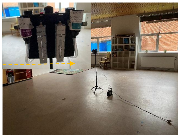
#58 Støvprøve P32-P33 og luftprøve MFAI10-MFAI11 er udtaget fra indeklimaet.
