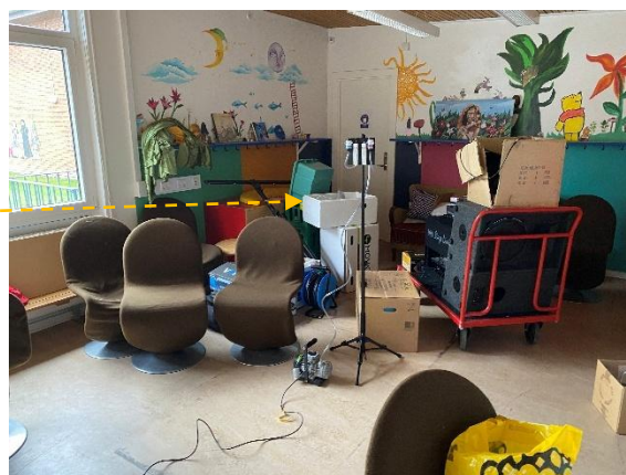
#84 Støvprøve P50-P51 og luftprøve MFAI22 er udtaget fra indeklimaet.
