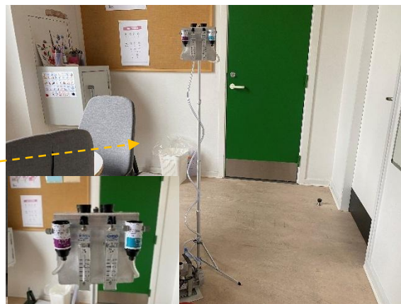
#92 Støvprøve P58-P59 og luftprøve MFAI26 er udtaget fra indeklimaet.
