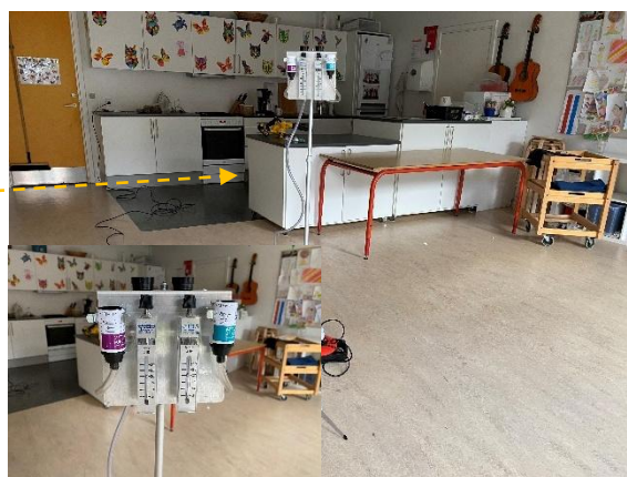
#64 Støvprøve P34-P35 og luftprøve MFAI12 er udtaget fra indeklimaet.
