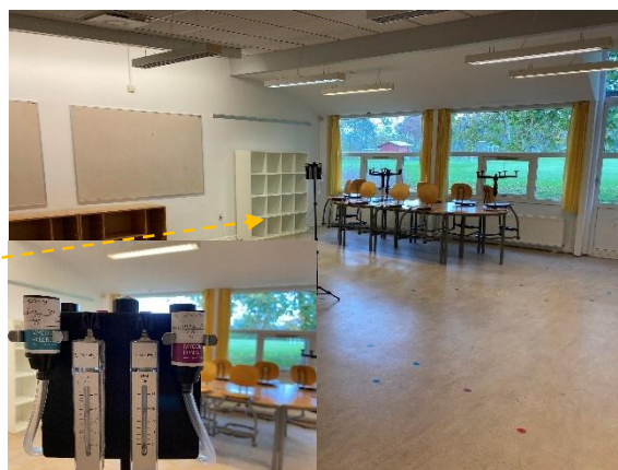
#108 Støvprøve P74-P75 og luftprøve MFAI34 er udtaget fra indeklimaet.
