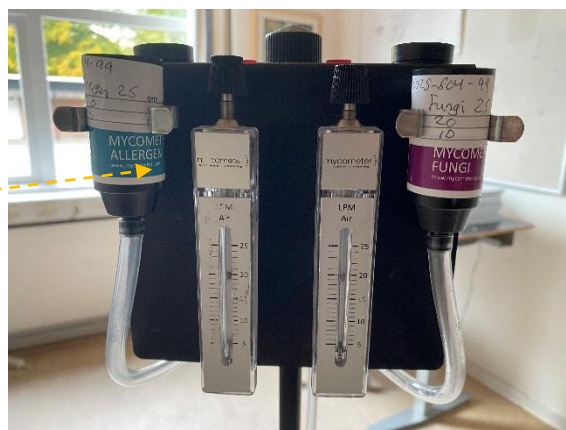
#90 Støvprøve P56-P57 og luftprøve MFAI25 er udtaget fra indeklimaet.
