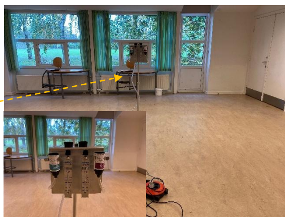
#106 Støvprøve P72-P73 og luftprøve MFAI33 er udtaget fra indeklimaet.
