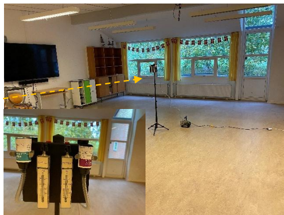
#104 Støvprøve P70-P71 og luftprøve MFAI32 er udtaget fra indeklimaet.
